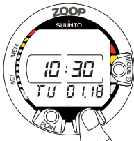
Abb. 2.1. Anzeige der Uhrzeit. Durch Drücken des Kontaktes PLAN oder DIVE wird das Display aktiviert.
